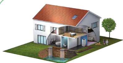
Captage eau de nappe
