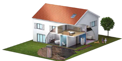
Captage sur sonde géothermique
